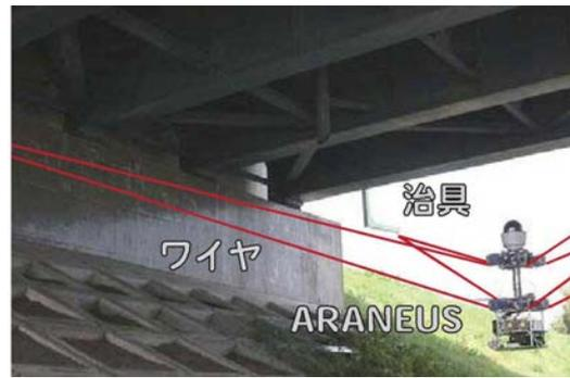
ワイヤー移動式橋梁点検ロボット
