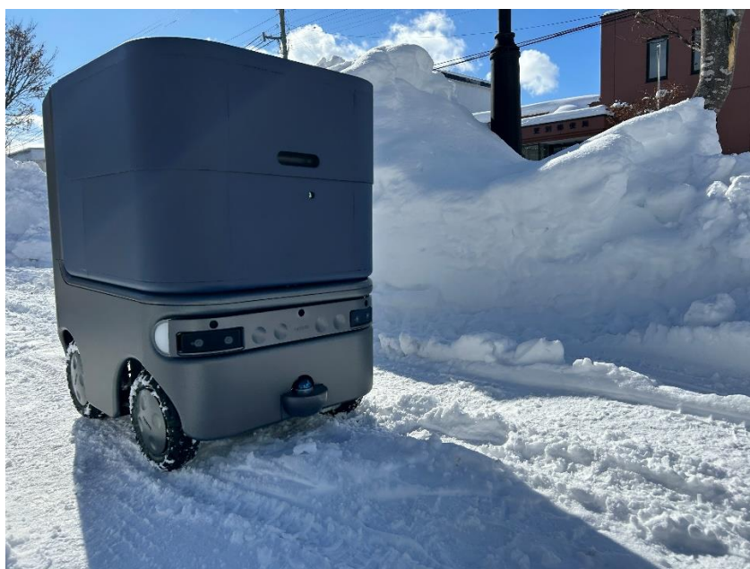
雪道の歩道を走行する低速・小型の自動配送ロボット
