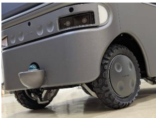
悪路環境下(雪道)での走破を目指し オフロードタイヤを装着して走行
