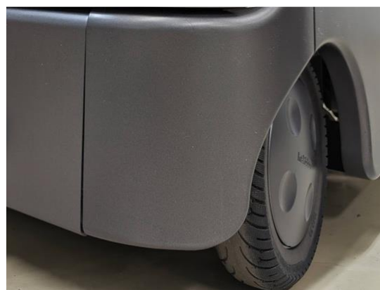
重量物の搬送もものともしない 標準仕様のノーパンクタイヤ
