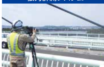
斜張橋ケーブル 張力計測システム
