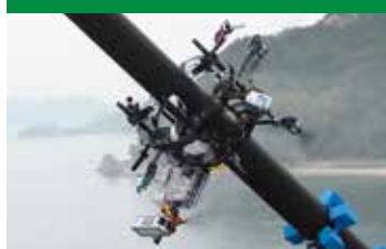
斜張橋ケーブル点検ロボット VESPINAE®
