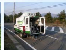
写真⑥舗装点検(FWD)
